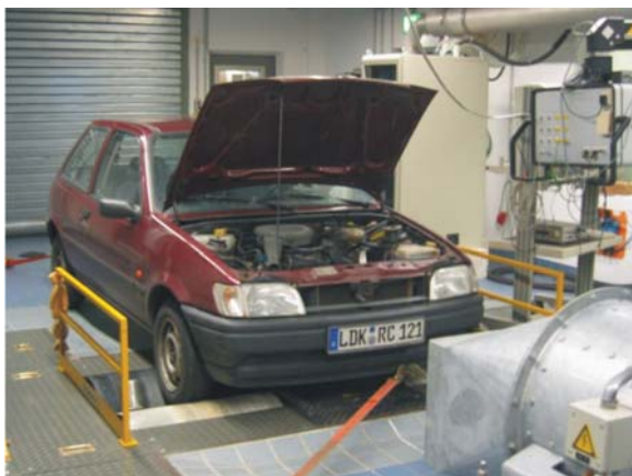
Leistungsmessung auf dem Rollenprüfstand
